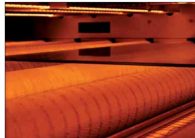
Innenansicht eines VSG-Brennofens mit Infrarotstrahlern aus dem Hause Klöpfer Maschinentechnik
