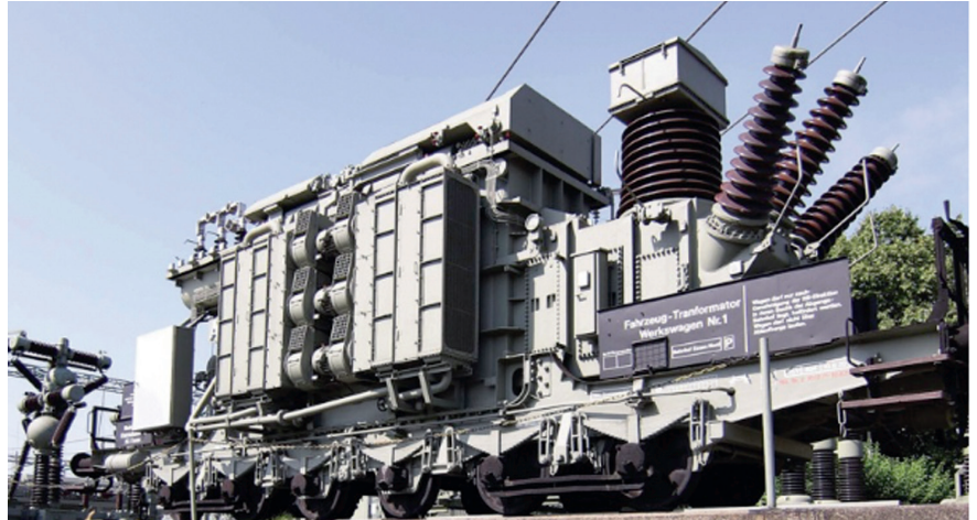
Fahrzeug-Transformator 110/25kV 60MVA, Baujahr 1937, AEG
