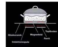
Bild 1: Funktionsweise Induktionsherd
