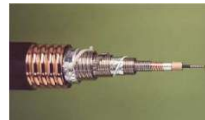
Supraleitendes 60-kV-Kabel Prototyp 1978
