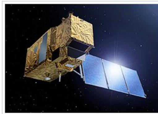
Sentinel-2 trägt ein optisches Instrument mit 13 Spektralkanälen. Es erzeugt hoch aufgelöste Bilder (10-60m) der Landoberfläche, die vor allem zur Beobachtung der Landbedeckung und -nutzung verwendet werden.
