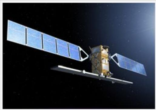
Sentinel-1 trägt ein C-Band Radarinstrument mit synthetischer Apertur (SAR). Es liefert hoch aufgelöste Bilder der Land- und Ozeanoberflächen. Es misst unabhängig von Beleuchtung (Tageszeit) und Wetter.
