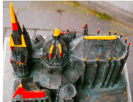
Aachener Dom: Blitzeinschlaggefährdete Bereiche für die Schutzklassen II (rot) und III (gelb) in der Draufsicht (Quelle: VDE)
