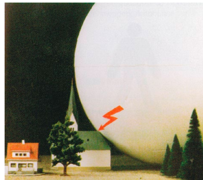
Blitzkugel-Verfahren bei einem Gebäudekomplex mit stark gegliederter Oberfläche: Die schraffierten Flächen sind mögliche Einschlagstellen des Blitzes, die durch Fangeinrichtungen geschützt werden müssen. (Quelle: VDE)
