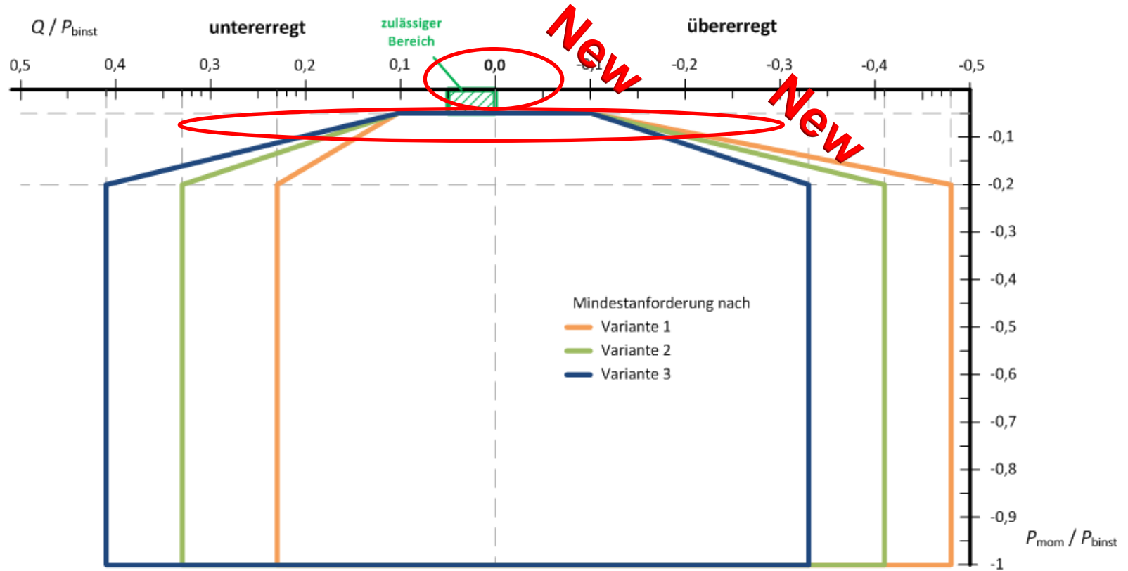
Bild 5 – Varianten der PQ-Diagramme der Erzeugungsanlage am Netzanschlusspunkt im Verbraucherzählpfeilsystem
