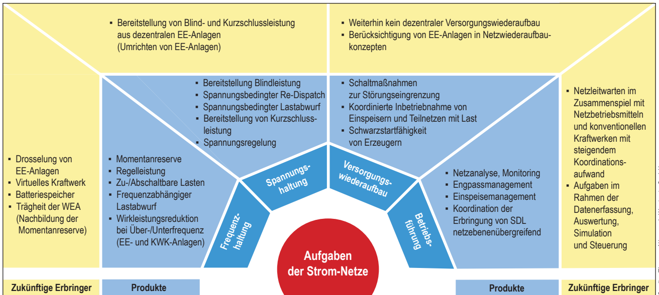
Abb. 6: Aufgaben der Strom-Netze bei dezentraler Energieversorgung
