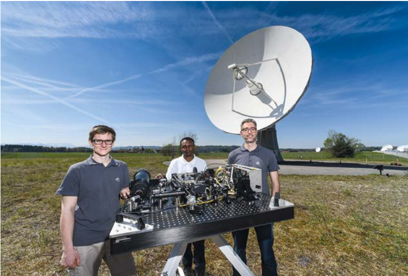
Der optische „Bodenterminal“ mit adaptiver Optik beim DLR Weilheim
