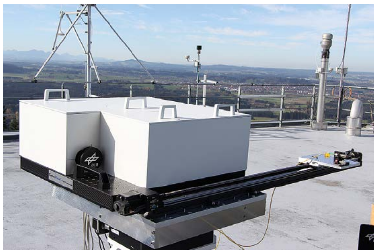
Der optische „Satellitenterminal“ beim Hohenpeißenberg; der Effekt der Satellitenbewegung wird durch eine seitlich Verschiebung der Sendelaser (auf die Schiene) nachgebildet. So können die DLR-Wissenschaftler verschiedene Kanalbedingungen untersuchen
