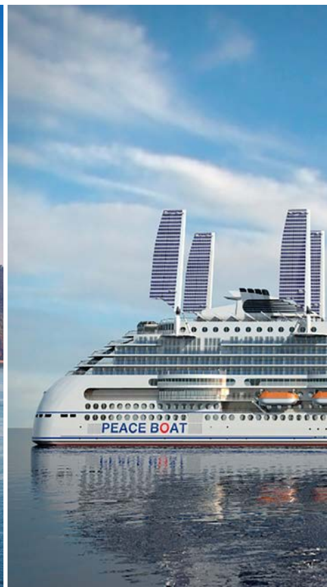
Möglichst umweltfreundlich um die Welt: Als erstes großes Containerschiff wird derzeit die „Sajir“ (l.) auf Erdgasbetrieb (LNG) umgerüstet. Das Gas verbrennt deutlich sauberer als Schweröl oder Diesel. Auch das neue „Peace Boat“ (r.) soll künftig mit LNG fahren. Zudem sollen große Segel mit Solarzellen den Treibstoffverbrauch verringern.
