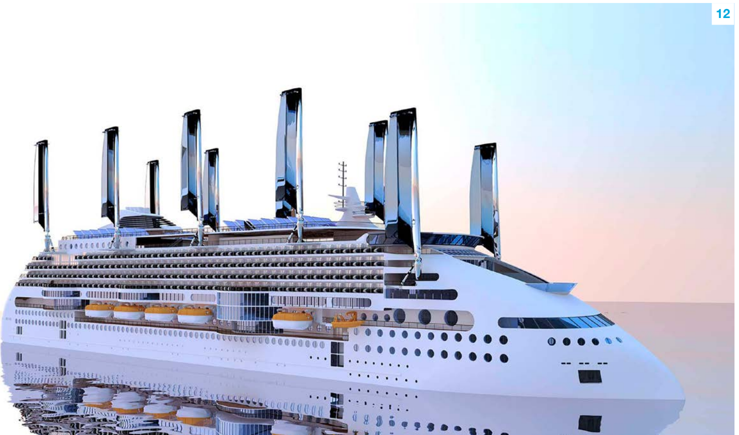
Umweltfreundlicher zur See: Erdgasbetriebene Schiffe könnten deutlich emissionsärmer auf den Weltmeeren unterwegs sein als herkömmlich mit Schweröl oder Diesel angetriebene. Weitere alternative Antriebsmodule wie große Segel mit Solarzellen könnten ebenfalls dabei helfen, den Treibstoffverbrauch zu verringern.
