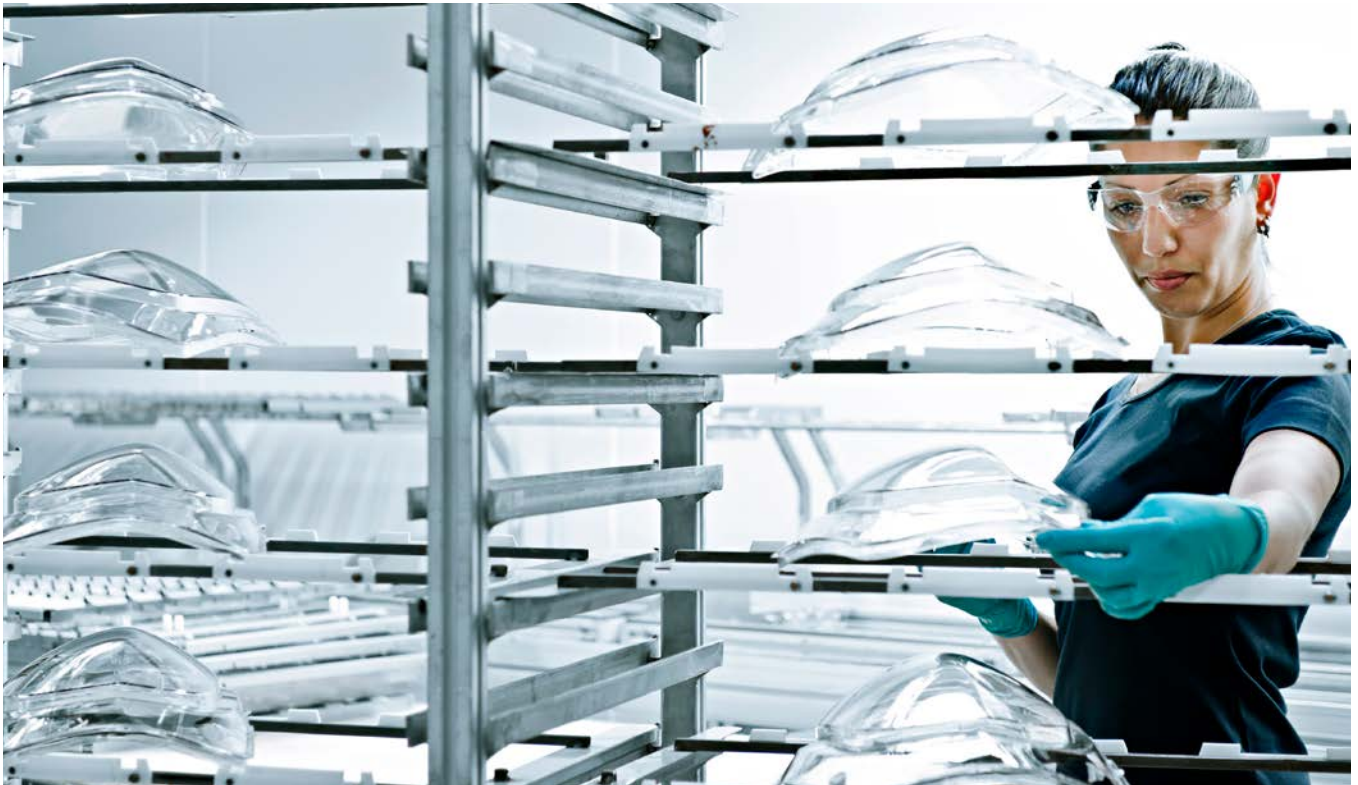
Extrem glatte Oberflächen mit außergewöhnlichem Tiefenglanz: Die multifunktionalen Kunststoffe von Nanogate SE verfügen über glasähnliche Elgenschaften, extreme Kratzfestigkeit und Gewichtsvorteile. Zum Einsatz kommen sie zum Beispiel als Scheiben in Spezialfahrzeugen oder auf Möbeln.
