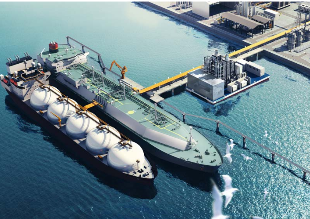
Ausgestattet mit zwei Gasturbinen aus dem schwedischen Werk in Finspong und einer Dampfturbine aus Görlitz, soll die schwimmende Gas- und Dampf-Anlage „Estrella del Mar III“ ab 2021 Santo Domingo mit Strom versorgen.
