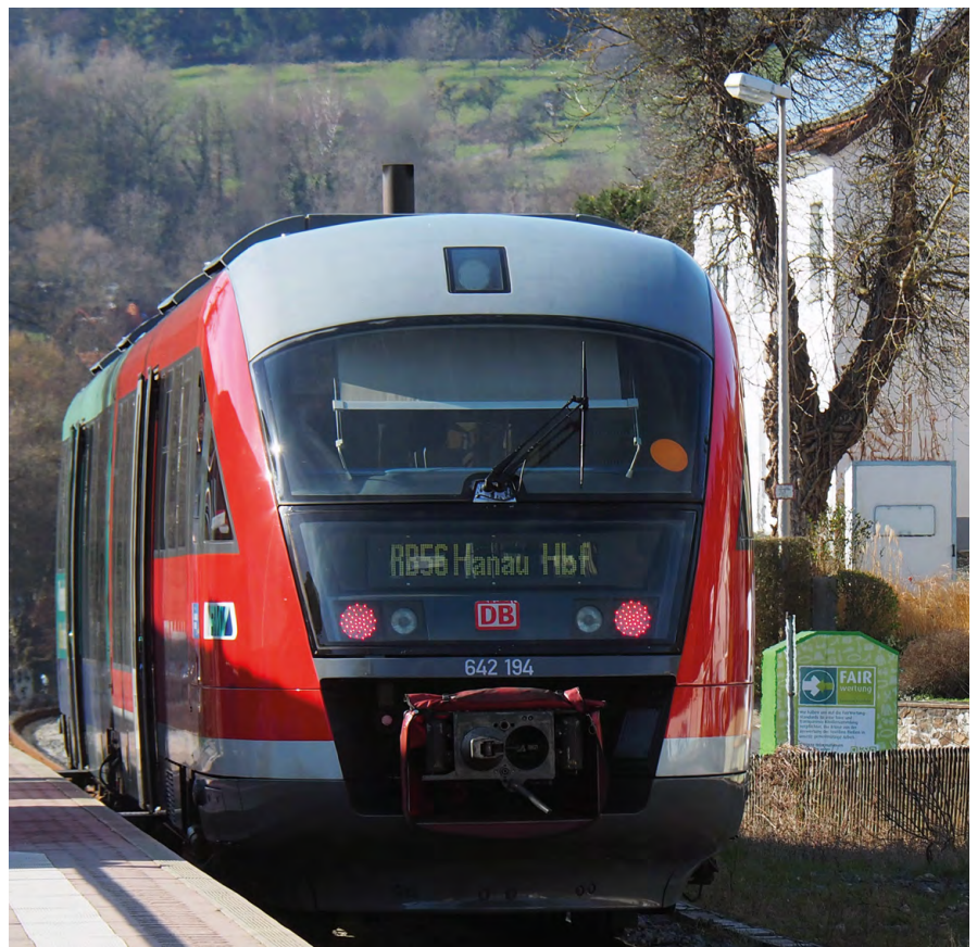
Abbildung 28 VT 642 Dieseltriebzug mit 2 x 275 kW Leistung (Euro II) (Foto: PH)
