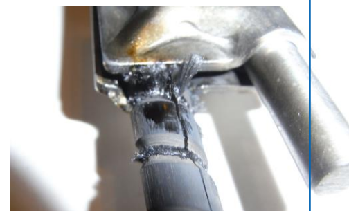
CFK-Stab nach Blitzstrombelastung (Quelle: DEHN SE)
