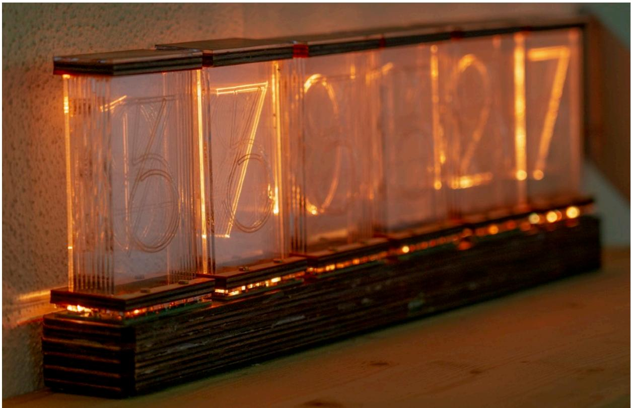
*Die „Lixieclock“ zeigt stilvoll die aktuelle Uhrzeit an - ohne auf Hochspannung oder fehleranfällige Nixie-Röhren angewiesen zu sein.*
