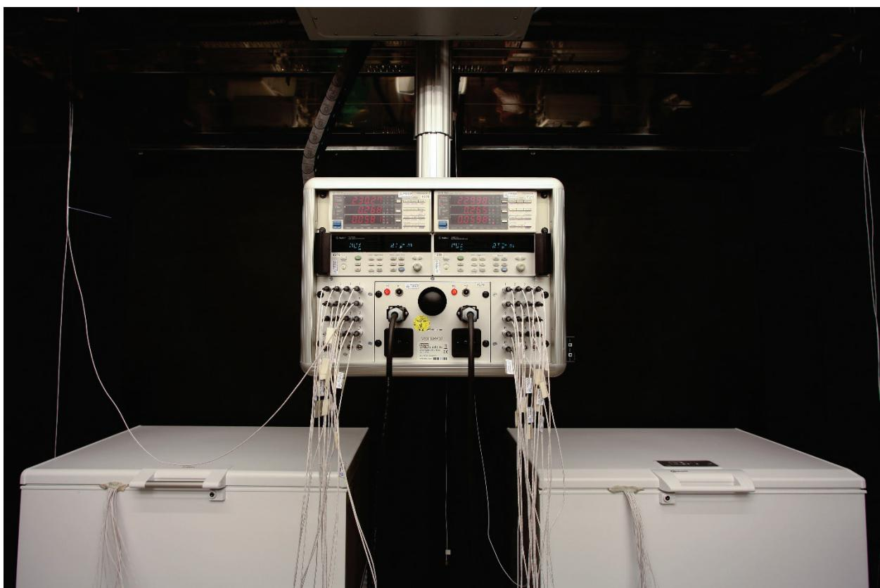
**VDE stellt vom Kühlschrank bis zum Ultra-Freezer alle Geräte auf den Prüfstand. Gerade die hochsensiblen Impfdosen verlangen äußerste Sorgfalt bei der Prüfung, schließlich geht es um Menschenleben. (Bildquelle: VDE Institut)**
