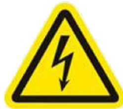
Bild 3 – Warnung vor elektrischer Spannung (Symbol ISO 7010-W012)
