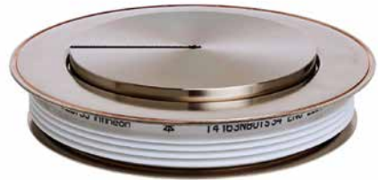
Thyristor zum Schalten sehr hoher Ströme und Spannungen (2000A, 8000V, Durchmesser bis 172mm/Höhe 40mm)
