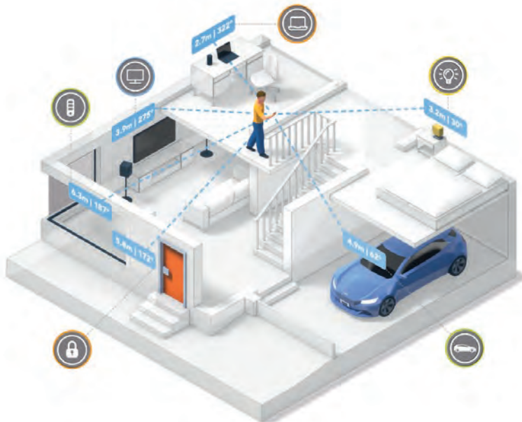
Abbildung 1: NXP Trimimension™ - Nutzung der UWB Funktechnologie als Entfernungs- und Richtungssensor im Smartphone, Fahrzeug und Internet der Dinge
