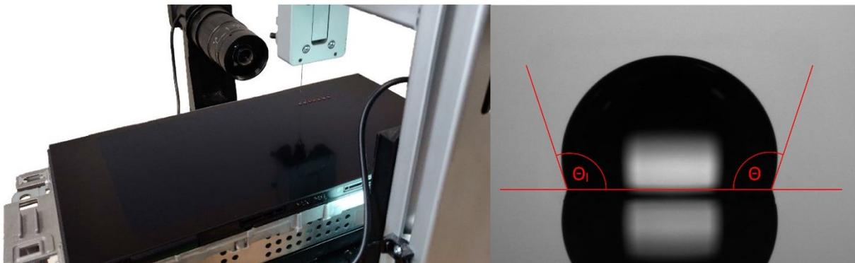
**Bild 9 – Kontaktwinkelmessgerät (QUELLE: Innowep GmbH)**
