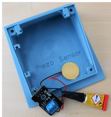
Bild 12: Verkleben des Piezo-Sensors im Dach
