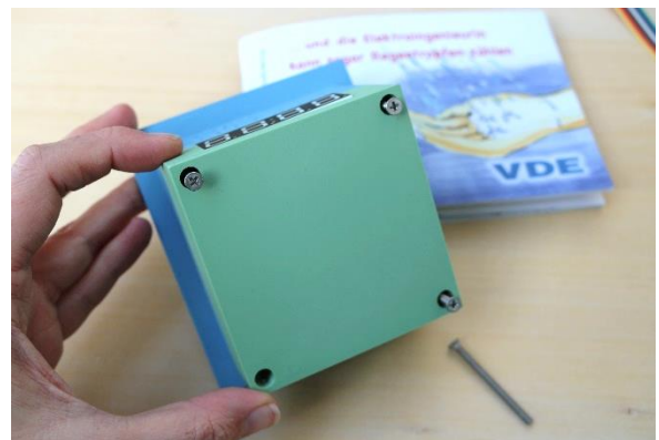
Bild 2: Boden und Dach verschrauben
