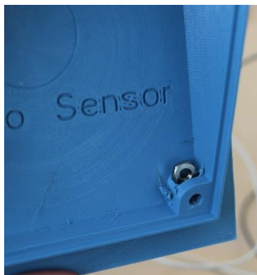
Bild 11: Einlegen der Mutter in die Dachecken
