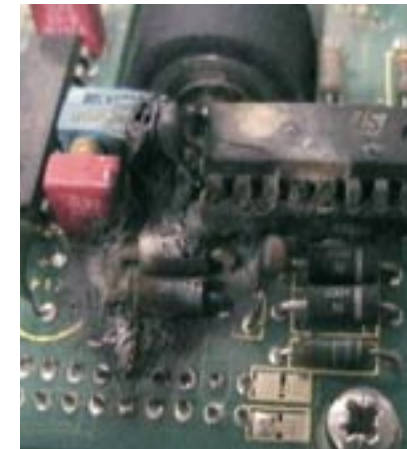
Schaden an Elektronik durch blitzbedingte Überspannungen
