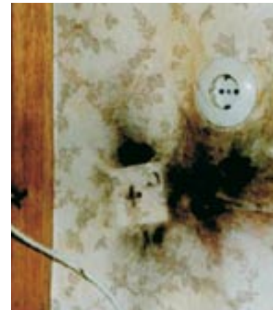
Wirkung von Blitzteilströmen
