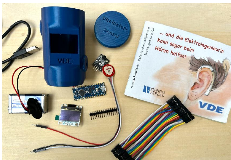
Bild 6: Bauteile Vitalsensor und Buch "... und die Elektroingenieurin kann sogar beim Hören helfen!"
