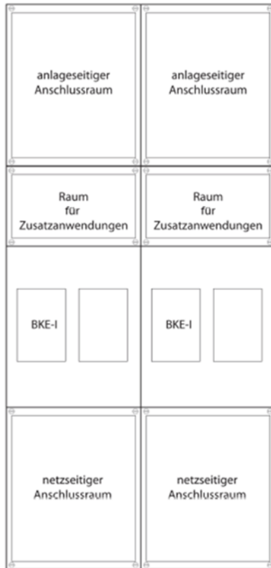
Bild 3 - Zählerplätze nach DIN 0603 für Zählerplätze mit Steckvorrichtung (Bsp. BKE-I)
