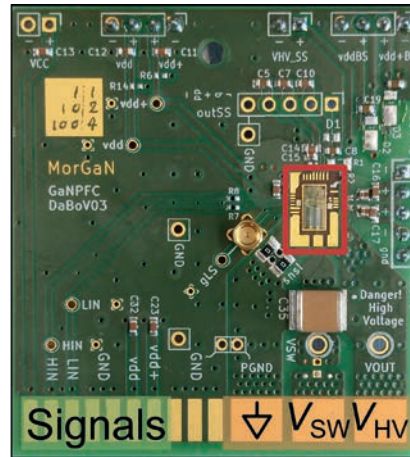
LINKS Leistungsstufe mit diskreten GaN-Transistoren im Vergleich zu einem GaN-IC für Totem-Pole-PFC-Netzteile RECHTS
