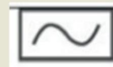
AC: Ab den 1950er-Jahren erhältlich und für die Installation in Haushalten vorgesehen; seit 1985 aber nicht mehr zugelassen. Erkennt ausschließlich sinusförmige Wechselfehlerströme. Auslösestrom 0,5–1,0 I<sub>ΔN</sub> (Nennfehlerstrom).
