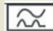
A: Anwendung in Haushalten, Gewerbe und für elektronische Betriebsmittel. Erkennt sinusförmige Wechselfehlerströme, pulsierende Gleichfehlerströme, angeschnittene Halbwellenströme, Halbwellenstrom mit DC-Überlagerung bis 6 mA. Reagiert nicht auf glatte Gleichfehlerströme und ist nur für 50 Hz geeignet. Auslösestrom 0,35–1,4 I<sub>ΔN</sub>. Der Untertyp F erkennt zusätzlich Frequenzgemische bis 1 kHz, reagiert aber auch nicht auf glatte Gleichfehlerströme.
