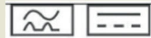
B: Anwendung im Gewerbe, insbesondere in Drehstromsystemen mit 50/60 Hz, nicht in Gleichspannungssystemen; seit 1994 erhältlich. Erkennt Fehlerströme die von Typ F erkannt werden, zusätzlich glatte Gleichfehlerströme. Allstromsensitiv, bis 2 kHz geeignet. Auslösestrom 0,5–2,0 I<sub>ΔN</sub>. Untertyp B+ erkennt zusätzlich Fehlerströme bis 20 kHz.
