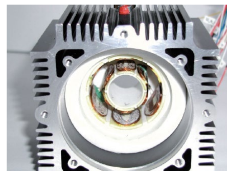
Bild 3: Ständer eines Versuchsträgers mit Luftspulenwicklung
