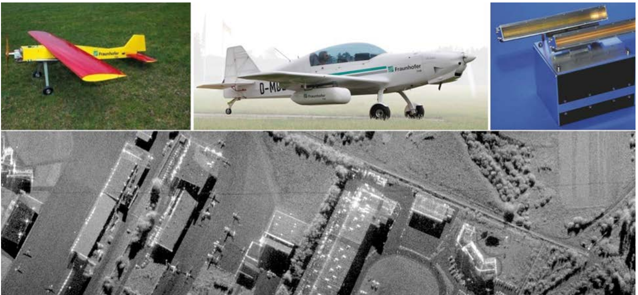
Abb. 5: SUMATRA ist eines der kleinsten SAR-Systeme der Welt (Frequenz: 94 GHz, Fraunhofer FHR, Halbleiter von Fraunhofer IAF)
