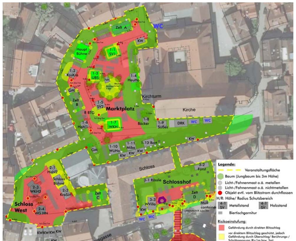
Bild 11: Blitzgefahrenplan mit gefährdeten und geschützten Bereichen
