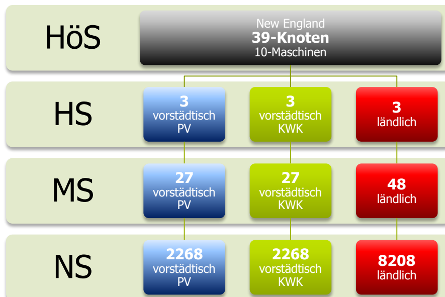
Abb. 17: Übersicht über das modellierte Testsystem
