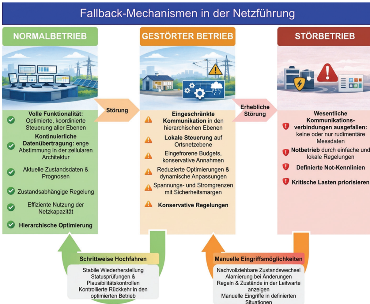
Abbildung 8: Das Prinzipbild zeigt die Fallback-Mechanismen in der Netzführung über die Zustände Normalbetrieb, gestörter Betrieb und Störbetrieb. Mit zunehmender Störung werden Kommunikation und Koordination reduziert, sodass die Steuerung schrittweise von optimierten, übergeordneten Prozessen hin zu lokalen und vereinfachten Regelungen übergeht.
